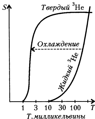
Рис. 29. Энтропия ^3\text{He} в жидкой и твердой фазах
